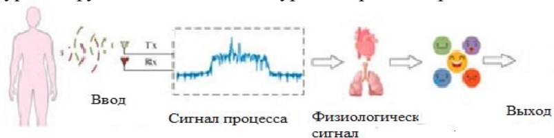
Рисунок 4 – Процесс распознавания эмоций на основе радарного датчика
