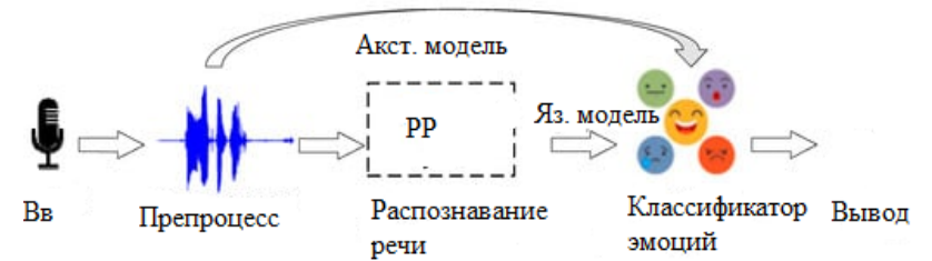
Рисунок 3 – Процесс распознавания эмоций аудиодатчиком
