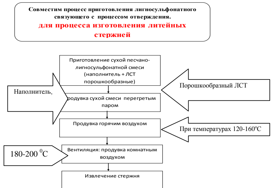
Рисунок 2 – Новая алгоритмика применения лигносульфонатных связующих в стержневых смесях, с использованием продувочных технологий
