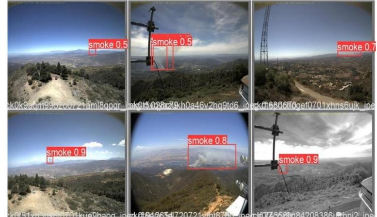
Рисунок 2 – Визуализация разработанной модели раннего обнаружения лесных пожаров
