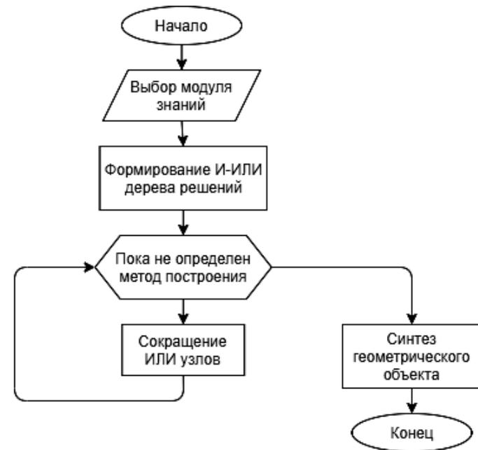
Рисунок 1 – Алгоритм логического вывода
