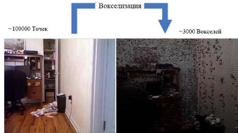
Рисунок 3 – Вокселизация данных полученных с сенсора Kinect ( $\Delta x = \Delta y = \Delta z = 2$  см)
