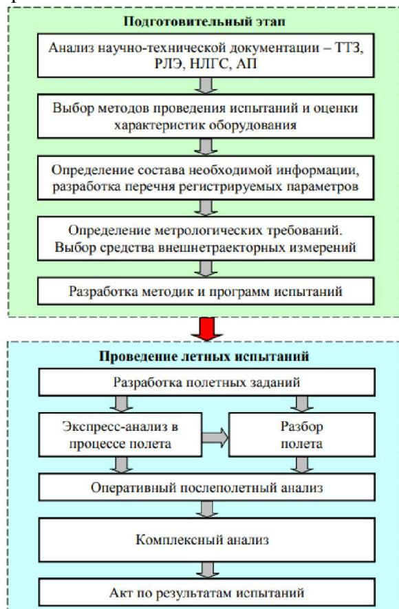
Рисунок 1 – Структурная схема организации испытаний
