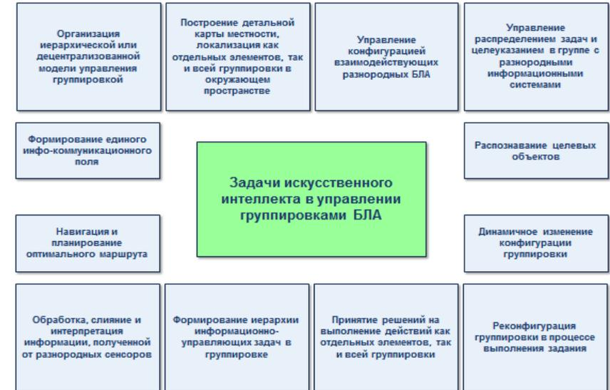
Рисунок 2 – Перечень задач ИИ для группового применения БЛА
