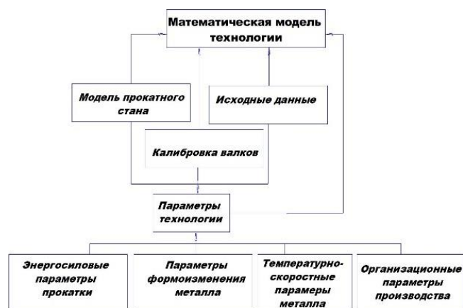
Рисунок 1 – Структурная схема математической модели сортовой прокатки
