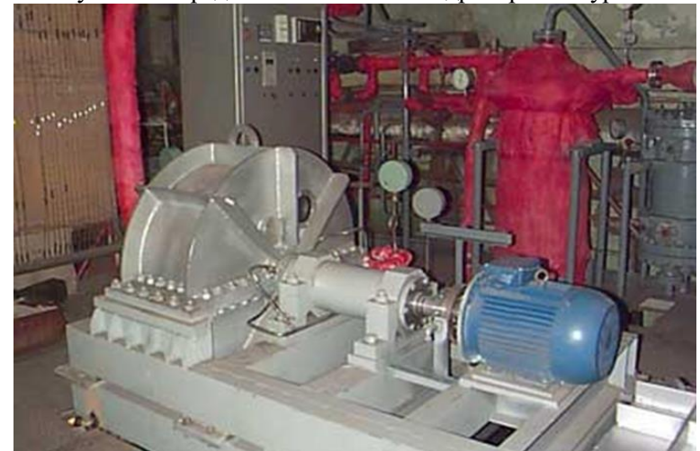
Рисунок 2 – Предлагаемая система гидропаровой турбины
