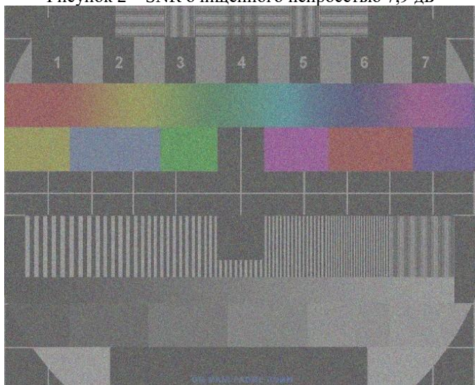
Рисунок 3 – SNR очищенного фильтром изображения 7,9 дБ
