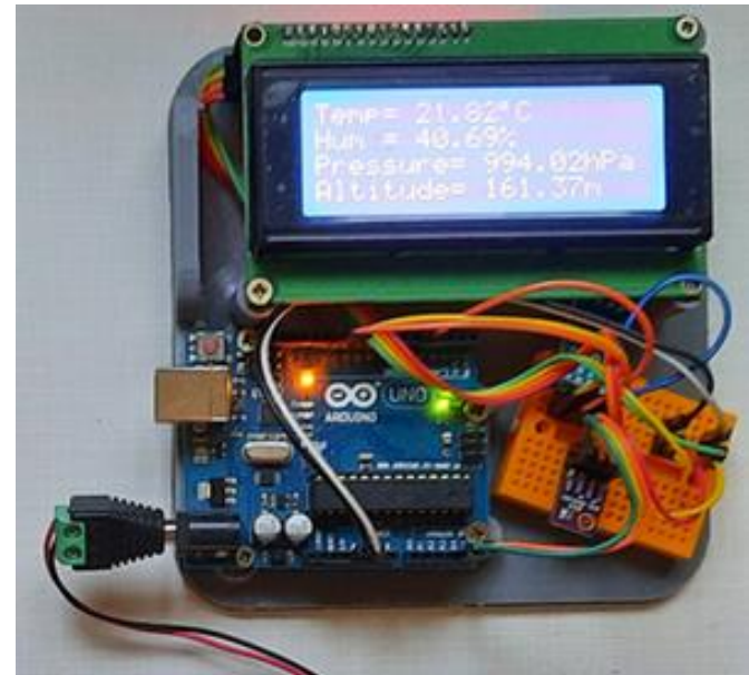
Рисунок 2 – Блок измерения параметров атмосферного воздуха
